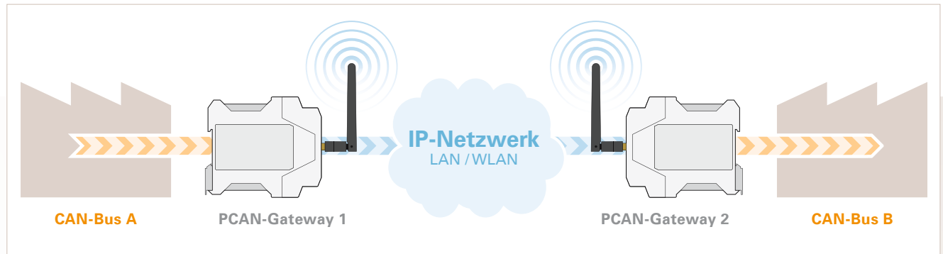
Beispiel 1: Unidirektionale Verbindung
