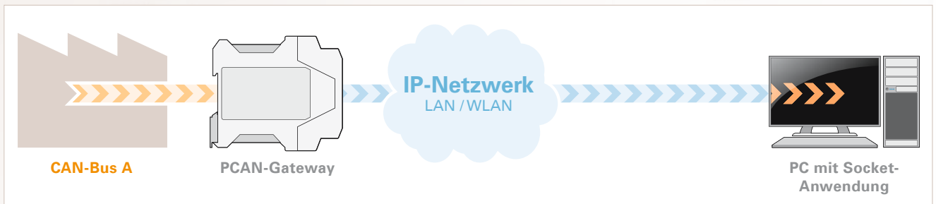
Beispiel 3: Verbindung über eine Socket-Anwendung
