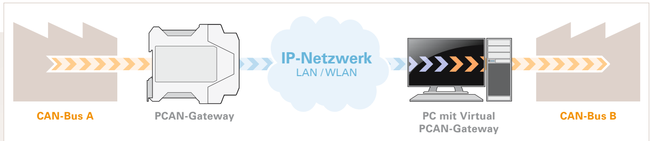
Beispiel 4: Verbindung über die Software Virtual PCAN-Gateway
