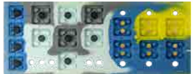
Silikonschaltmatte mit Kontaktpillen aus Karbon und Gold und Stabilisatoren
