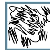
**Teilkristalline Thermoplaste** bilden beim Abkühlen dichte Kristalle. Sie sind opak, mechanisch fester, härter, zäher, chemikalienresistent und haben eine höhere Wärmeformbeständigkeit.
